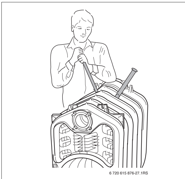
Fig. 27 Détacher le bloc chaudière
