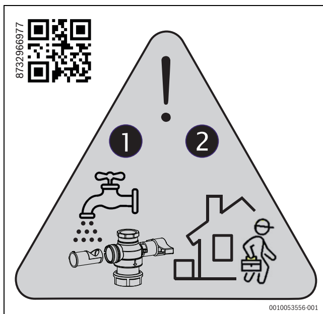
Fig. 54 Nettoyage du filtre à particules après la maintenance
