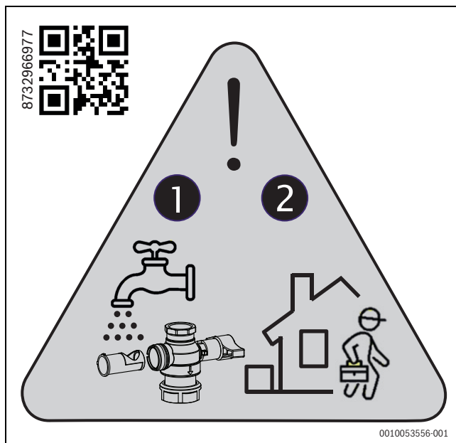
Fig. 42 Nettoyage du filtre à particules après la mise en service et la maintenance
